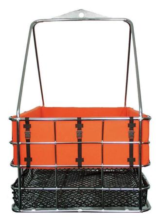
Il cesto #496 è stato specificatamente progettato per il sollevamento attraverso il portello del pavimento dell'elicottero CH-47 Chinook utilizzando l'argano interno. Il design semplice, costruito in acciaio inox tubolare, è facile da conservare e manovrare. Il fondo è racchiuso da un rivestimento a rete in plastica con aperture da 1" (vedi #495).
